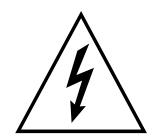
Dieses Symbol verweist auf nicht-isolierte Stromspannungen im Geräte-Innern, welche zu einem elektrischen Schlag führen könnten.
